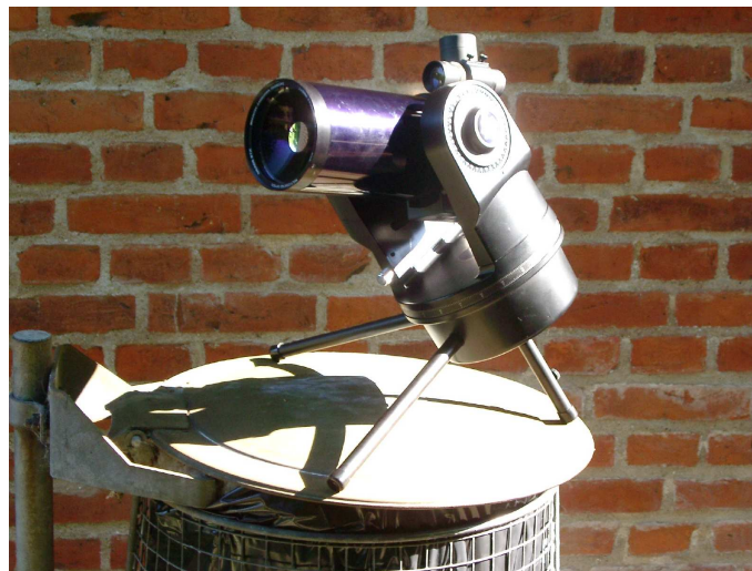
Figur 1: Den første model af Meade ETX teleskopet uden automatisk styring på bordstativ
