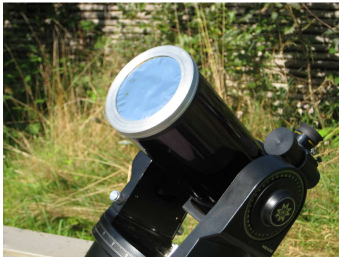
Figur 5: ETX teleskop med mylar solfilter
