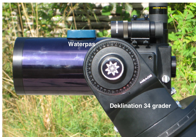
Figur 3: Teleskopet står vandret ved en deklination på 90 grader minus breddegraden – 34 grader på Hven
